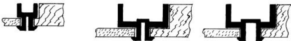
Il fissaggio dei profili a parete è molto semplice. La soluzione più pratica consiste nell'utilizzare gli art. 0341 – 0343 – 0345 – 0348 che portano dei fori di Ø 4 mm. a distanza variabile secondo le altezze, e si montano a parete utilizzando viti complete di tasselli.
